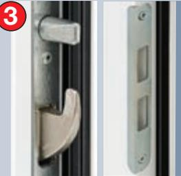
So fühlen Sie sich sicher zu Hause: 2 konische Schwenkriegel rasten mit 2 zusätzlichen Sicherungsbolzen sowie 1 Schlossriegel in die Schließbleche der Zarge ein und ziehen die Tür fest an. Auf der Bandseite machen 3 weitere Sicherungsbolzen ein Aushebeln der Tür praktisch unmöglich.
